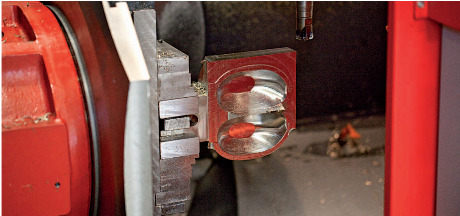
Darstellung des Arbeitsraumes der MAXXMILL 500 während der Fertigung der Pelton-Turbinenschaukel
