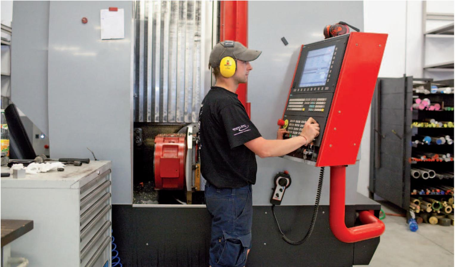
Komplettes Fertigen in nur einer Aufspannung: Die Fachleute von Weico Maschinen- und Metallbau sehen diese Erwartung an die MAXXMILL 500 erfüllt und übertroffen: Aus kürzerer Fertigungszeit und Bearbeiten in einer Aufspannung ergeben sich höhere Effizienz und Präzision.
