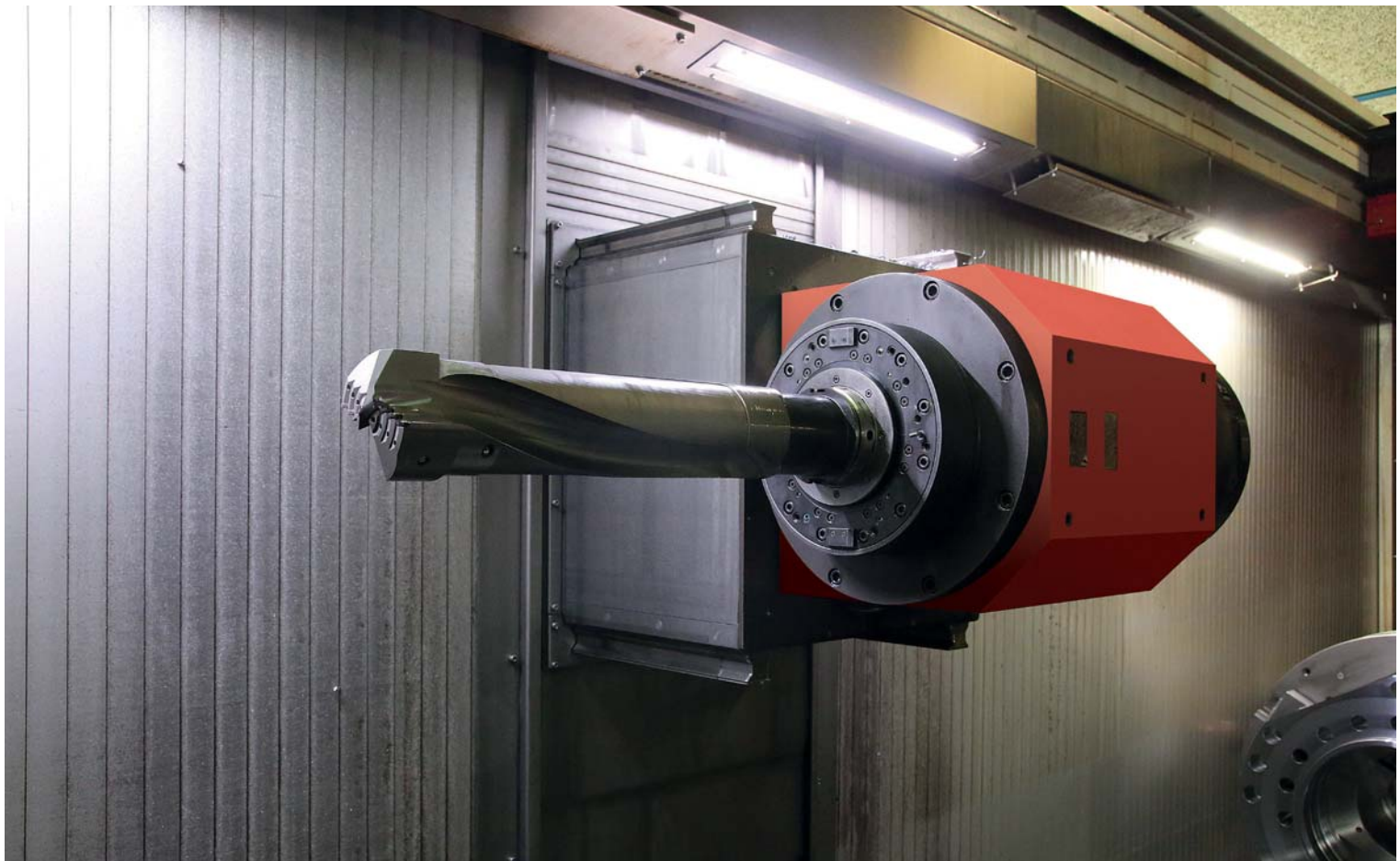
Für höchste Zerspanungsleistung ausgelegt: die Frässpindel bietet 630 Nm, eine max. Drehzahl von 6.500 min -1 , sowie 80 kW Antriebsleistung.
