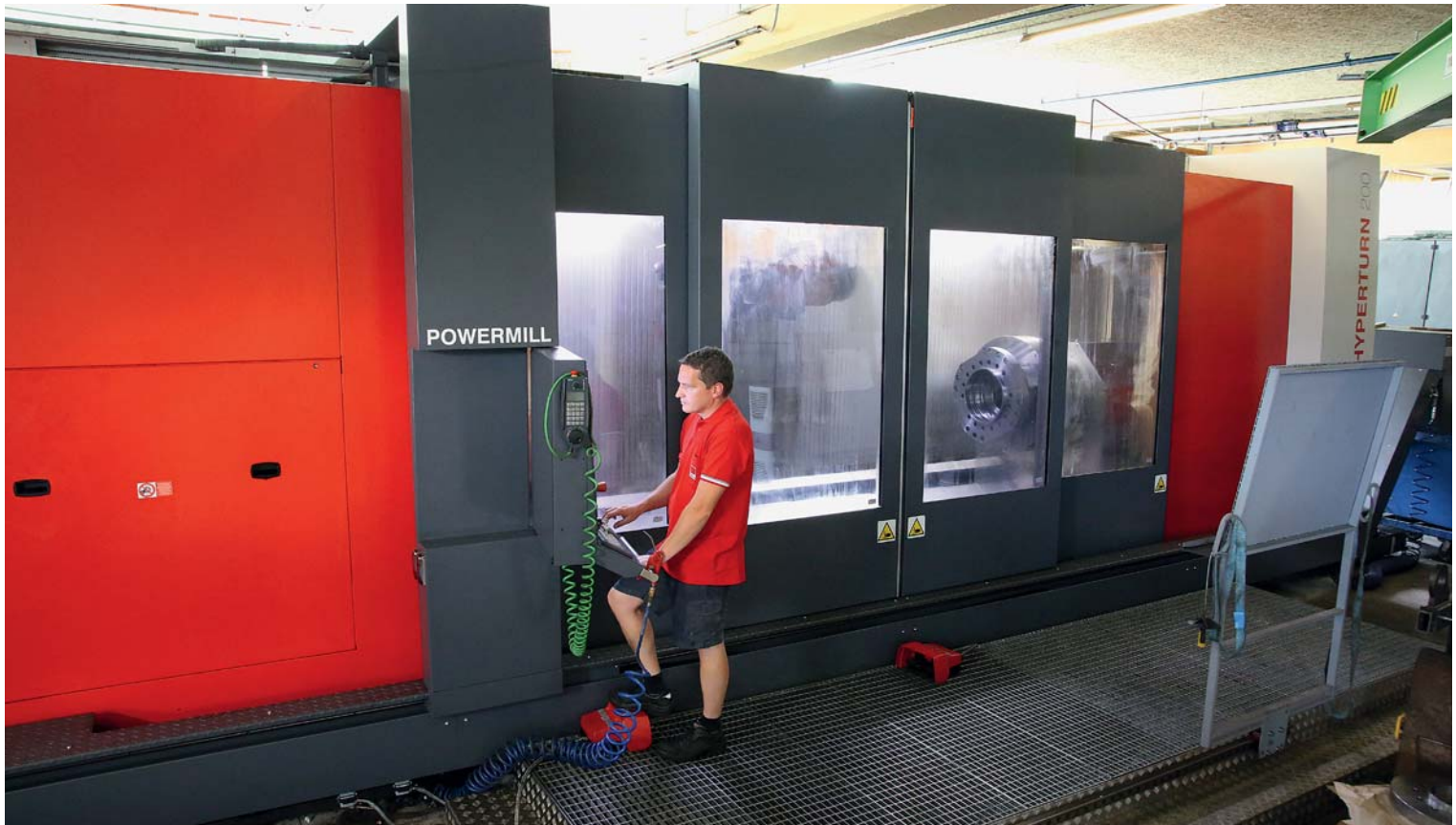
Beeindruckende Größe: Die Hyperturn 200 Powermill von Emco ist die größte Werkzeugmaschine bei GMT Wintersteller und fertigt seit 2017 komplexe Großteile in einer Aufspannung.
