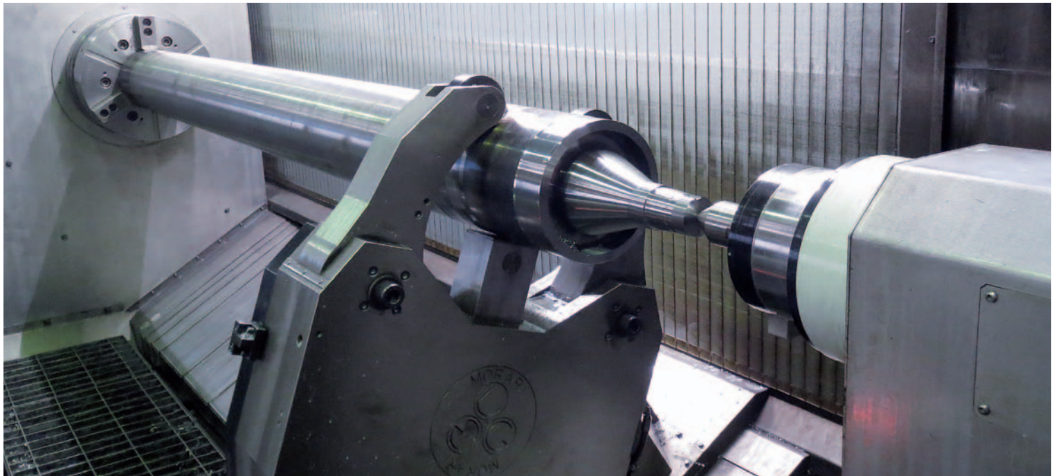
Folienwalzen mit einem Durchmesser von 350 x 3800 mm mit Lünette und Reitstock abgestützt
